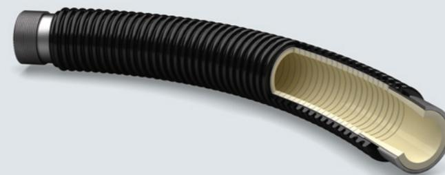
CERA SYSTEM liefert verschleißfeste flexible Lösungen. Überall wo in regelmäßigen Abständen Schläuche verschleifen und gewechselt werden müssen, können Keramikschräuche von CERA SYSTEM eingesetzt werden. Der Schlauch besteht aus Keramikringen, die mit speziellen bewehrten Gummimaterialien zusammenvulkanisiert werden. Drücke bis zu 10 bar sind zulässig.
