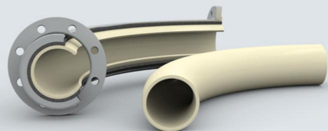
CERA SYSTEM bietet verschleißfeste Rohrbögen, Y- und T-Stücke sowie andere Formstücke an. Zum Einsatz kommen die unterschiedlichsten Keramiken. Die Keramik ist massiv (Wandstärke ca. 6mm). Alle Lösungen sind nennweitenkonform, sie können ohne Änderung der Rohrleitungen problemlos montiert werden. Die lichte Weite entspricht dem Flanschanschluss. Unsere Besonderheit: die keramischen Rohrbögen sind tatsächlich gebogen (keine Anreicherung von geraden Abschnitten).
