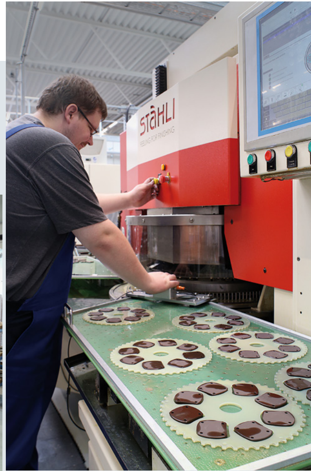
Anschließend werden die gesinterten Teile geschliffen und poliert.
